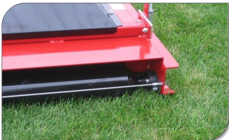
Looprol met schraapkabel en binnenwerks gemonteerd flenslager
